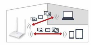
使用5dBi雙天線,及標準11n規格進行傳輸,傳輸速率可達300Mbps。除了提升無線速度外,新技術還可以將發送的無線訊號引導至正確的方向改善死角接收問題。讓您可以享受更快捷的無線網路、更穩定的高畫質影音及其他豐富的數據內容。也支援智慧型手機及平板電腦無障礙地享受播放影音串流媒體。
